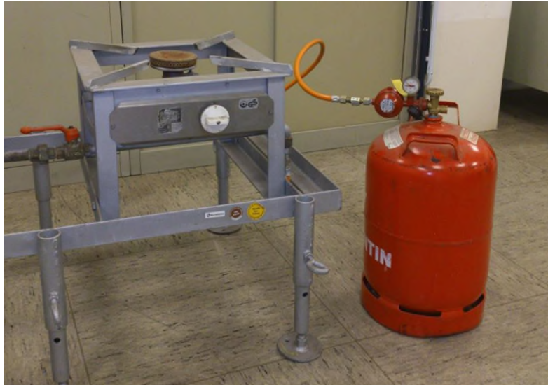
Abb. 9: Flüssiggasanlage mit Versorgungsanlage und Verbrauchsanlage
