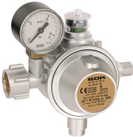
Abb. 12: Zweistufiges Druckregelgerät für den Gewerbebereich mit Überdrucksicherheits-einrichtung, Sichtanzeige und integrierter Schlauchbruchsicherung (Quelle: Fa. GOK, www.gok-online.de )
